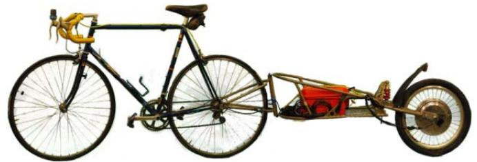
FIGURE 1. PROTOTYPE ELECTRIC BICYCLE TRAILER
